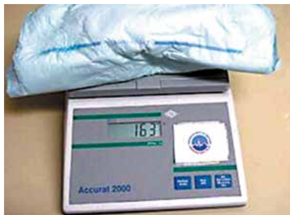
Рис. 4. Тест с прокладкой. Взвешивание прокладок на электронных весах
